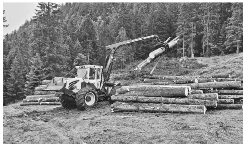
Erschliessung Stockboden mit Forstschlepper HSM.
