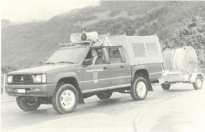
Zugfahrzeug mit Verlegeanhänger mit Schläuchen Ø 75 mm (500 m)
