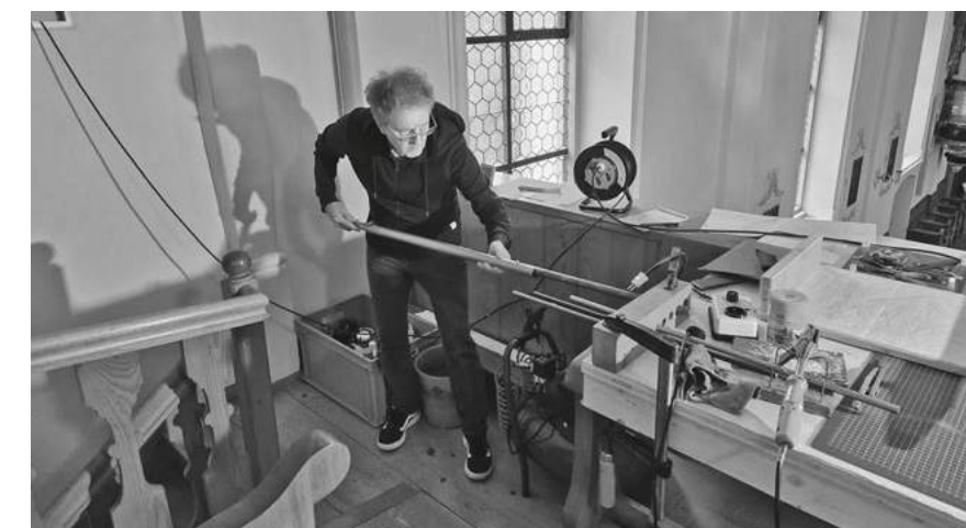
Andreas Zwingli, Geschäftsleiter der Späth Orgelbau AG, beim fachgerechten Ausbeulen kleinerer Verformungen an den Orgelpfeifen.
