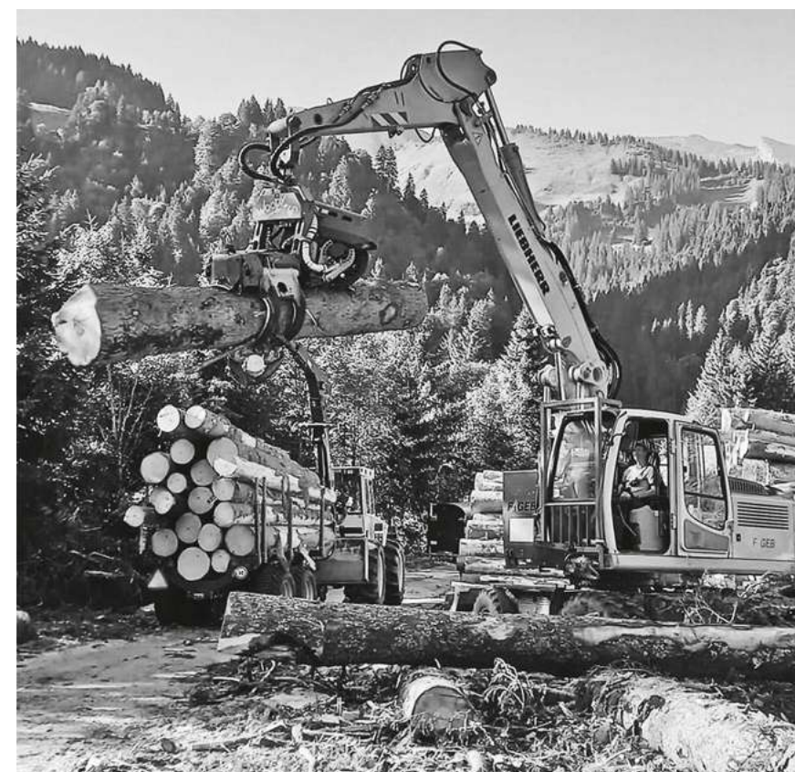
Der Baggerprozessor im Einsatz mit Maschinist und Forstwart Urs Käslin.
